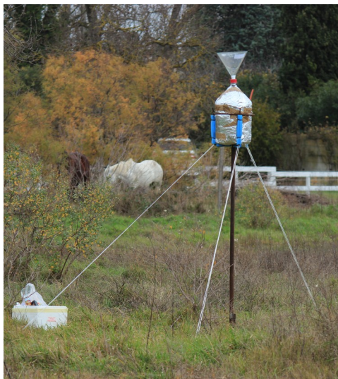
Figure 3.3 : Photo de la jauge Owen mise en place sur le site 2
